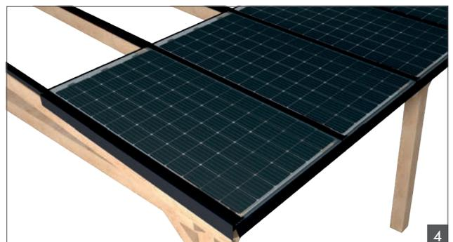
4 Weitere Keilreihe und Solarpressleisten montieren
